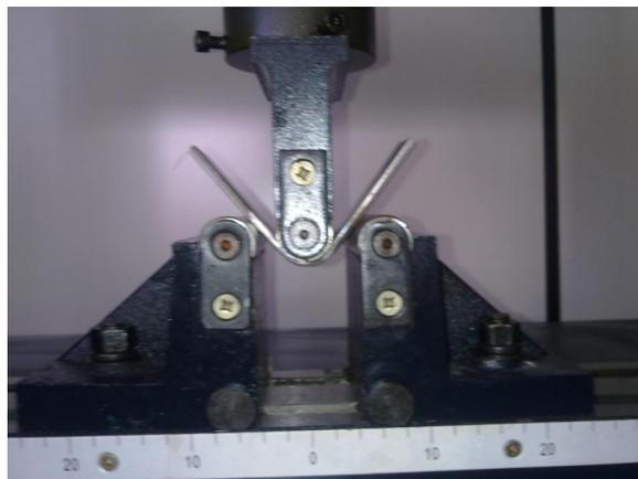
Figura 12 - Máquina de Ensaio Universal durante ensaio de dobramento ( $90^\circ$ ).
