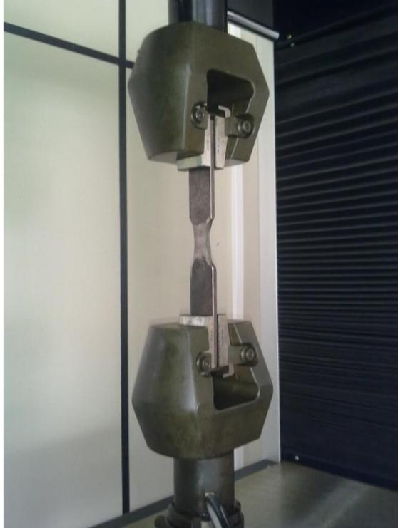
**Figura 8 - Máquina de ensaio universal durante ensaio de tração.**
