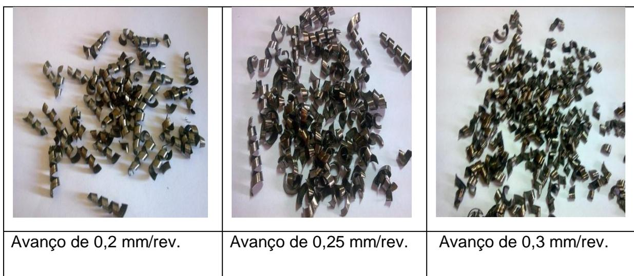
Figura 33 – Velocidade de corte ( $V_c$ ) de 150 m/min e avanço ( $f$ ) de (0,2, 0,25 e 0,3) mm/rev.
