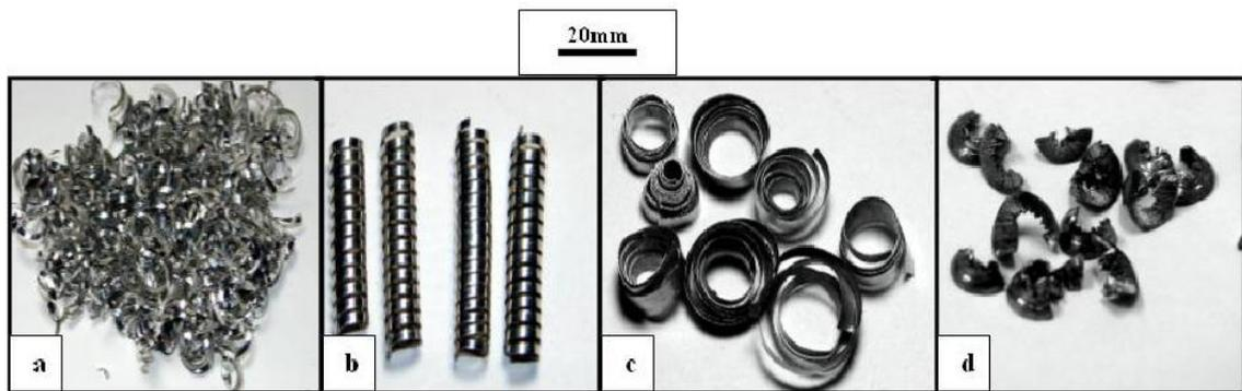
Figura 2 - Diferentes formas que os cavacos assumem quando são gerados durante operações de torneamento. (a) fita, (b) helicoidal, (c) espiral e (d) em lascas (Tungaloy, 2008).
