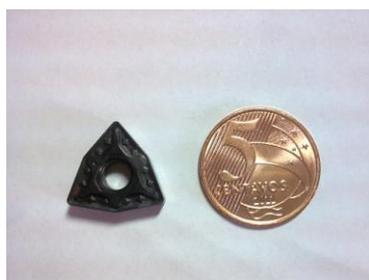
**Figura 5 – Ferramenta de corte de metal duro.**
