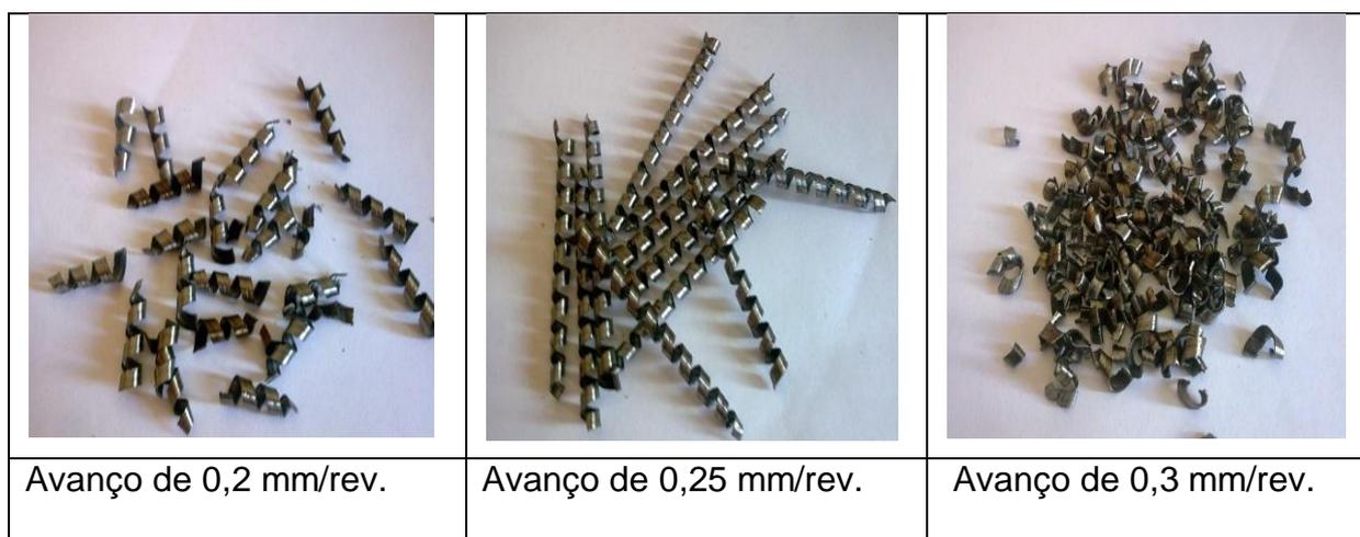
Figura 32 - Velocidade de corte ( $V_c$ ) de 100 m/min e avanço ( $f$ ) de (0,2, 0,25 e 0,3) mm/rev.
