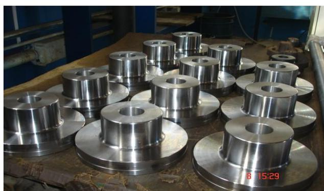
**Figura 19 - Corpo de válvula peça pronta**
