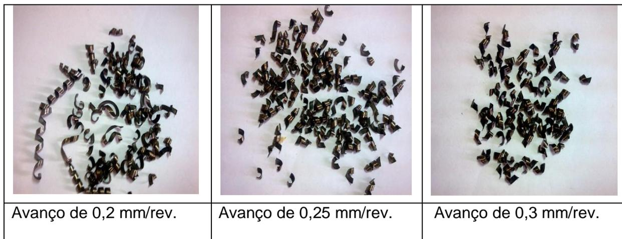
Figura 34 – Velocidade de corte ( $V_c$ ) de 200 m/min e avanço ( $f$ ) de (0,2, 0,25 e 0,3) mm/rev.
