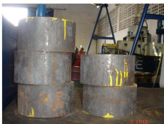
**Figura – 17 Tarugo cortado de Aço SAE 4140**
