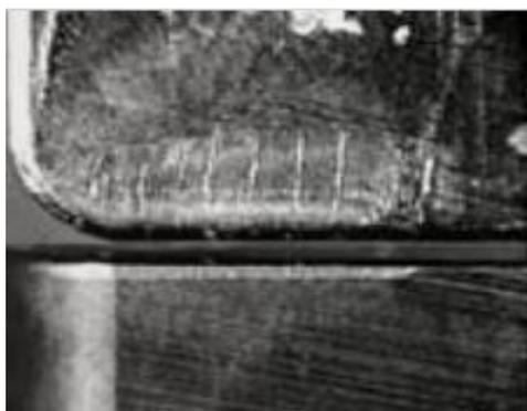
**Figura 7- Trinca térmica (Tungaloy, 2008).**
